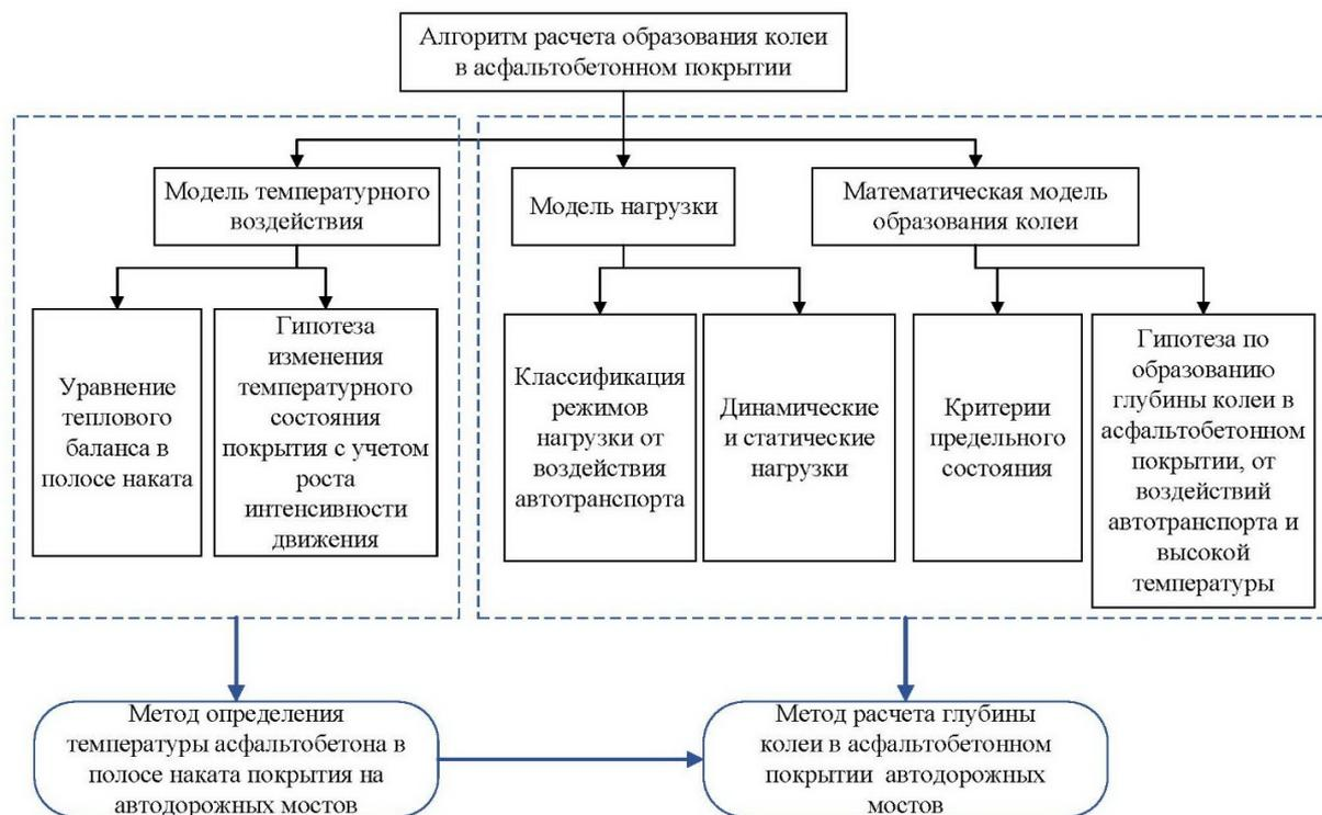
Рис. 2. Алгоритм расчета образования колеи в асфальтобетонном покрытии на автодорожных мостах
