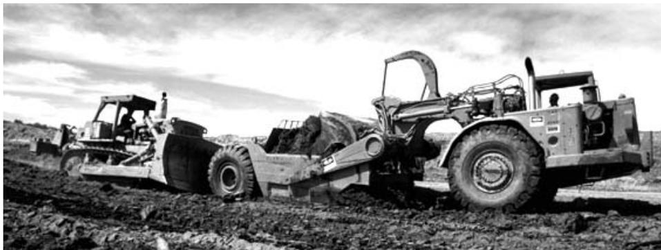
**Рис. 1.** Заполнение ковша скрепера с толкачом
