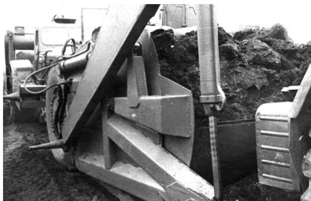
**Рис. 3.** Заполнение ковша с совковым режущим органом
