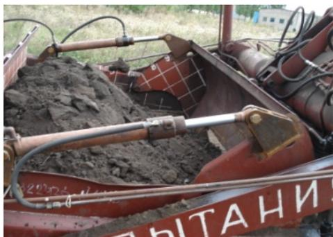
Рис. 7. Заполнение ковша в условиях свободного резания при ширине меньше 1,6 м
