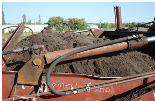
Рис. 8. Заполнение ковша в условиях свободного резания при перемещении задней стенки
